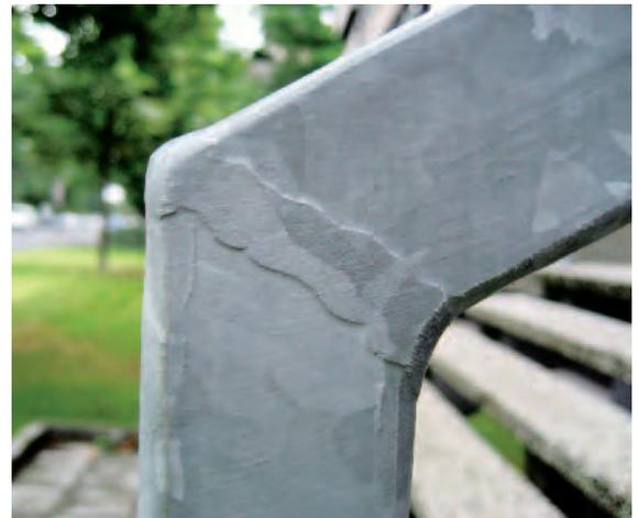
➔ Abb. 18: Aufgewachsener Zinküberzug an blecheben geschliffener Schweißnaht
