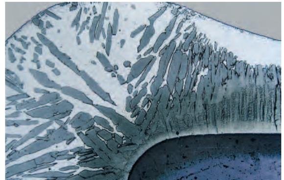
➔ Abb. 7: Schlibbild eines typischen Zinküberzuges
