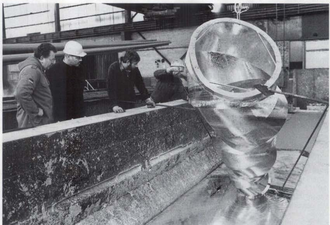
Abb. 15: Eines der drei Skulpturenteile im Zinkbad.
