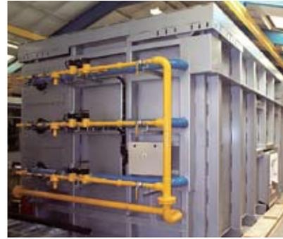
Moderne Verzinkungsöfen sind computergesteuert und extrem effizient. Abwärme wird dazu verwendet, die Bäder der Vorbehandlung zu heizen oder den Trockenofen zu betreiben.
