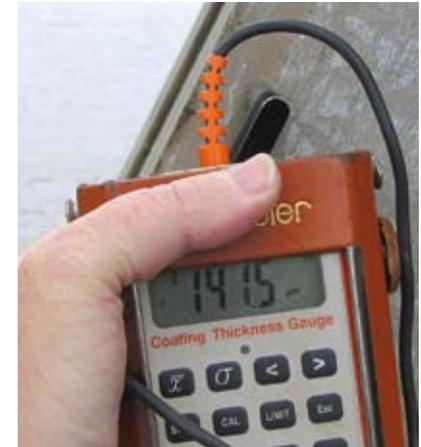
Alte feuerverzinkte Stahlkonstruktionen, die auch noch nach Jahrzehnten dem Rost trotzen, sieht man an vielen Orten. An den wenigsten dieser Bauwerke wird im Zeitverlauf die Schichtdicke der Feuerverzinkung gemessen. Eine der wenigen Ausnahmen ist die Ehzerbrücke im niederländischen Almen.
