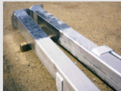
Abb. 5: Zusammengesetztes Bauteil mit unterschiedlich ausgeprägten Zinkschichten
