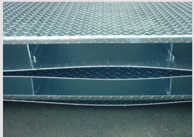
Abb. 2: Verzug an einem Bauteil durch Eigenspannungen
