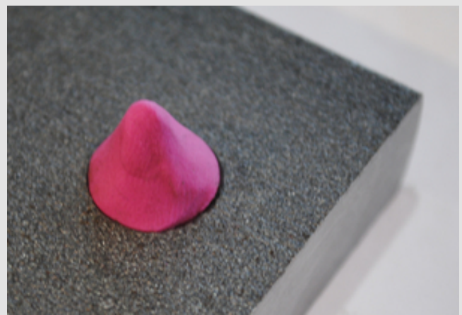
Abb. 4: Sacklöcher können durch geeignete Knetmassen zur Vermeidung der Zinkannahme verschlossen werden.
