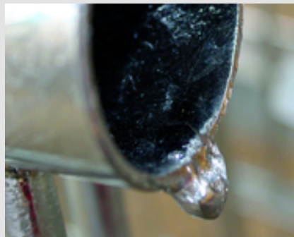
➔ Abb. 2: Abfließendes Zink kann in Form von Tropfnasen und Verdickungen erstarren.
