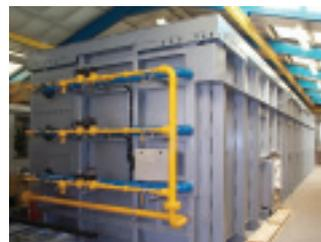
Moderne Verzinkungsöfen sind computergesteuert und extrem effizient. Abwärme wird dazu verwendet, die Bäder der Vorbehandlung zu heizen oder den Trockenofen zu betreiben.
