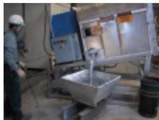
Zinkasche und Hartzink, die sich in dem Feuerverzinkungsbad bilden, können entweder vor Ort oder durch spezielle Recyclingfirmen vollständig recycelt werden. Verzinkereien betreiben hierzu kleine Öfen, um metallisches Zink aus Prozessasche wiederzugewinnen. Dieses metallische Zink kann dem Feuerverzinkungsbad direkt wieder zugeführt werden, ohne den Standort zu verlassen.
