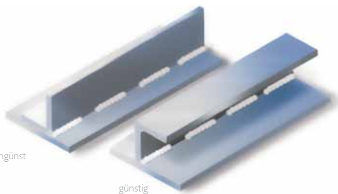
Abb. 4: Großflächige Überlappung bei Schweißkonstruktionen vermeiden!
