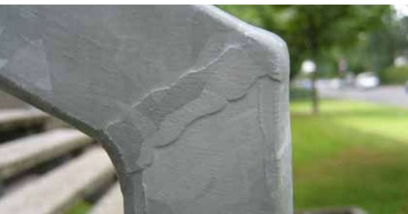
Abb. 2: Aufgewachsener Zinküberzug an blecheben geschliffener Schweißnaht.
