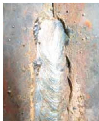
Abb. 3: Einbrandkerben müssen vermieden werden!
