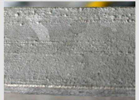
➔ Abb. 5: Unebene Zinkoberfläche durch Ungänzen im Stahlwerkstoff.
