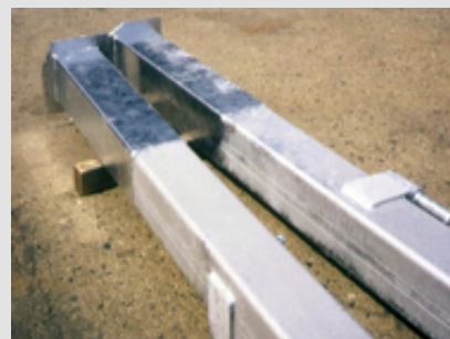
Abb. 5: Zusammengesetztes Bauteil mit unterschiedlich ausgeprägten Zinkschichten
