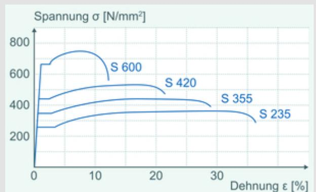
Abb. 2: Spannungs-Dehnungsdiagramm
