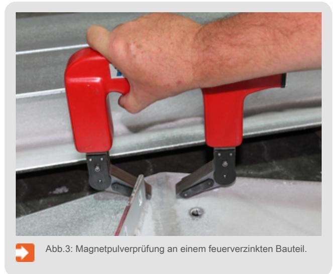
Abb.3: Magnetpulverprüfung an einem feuerverzinkten Bauteil.
