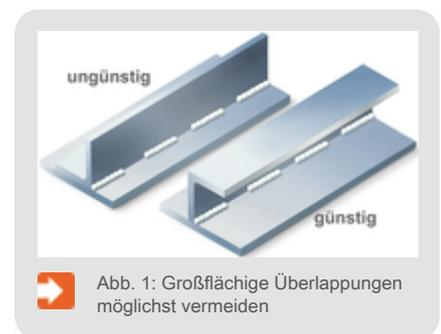
Abb. 1: Großflächige Überlappungen möglichst vermeiden
