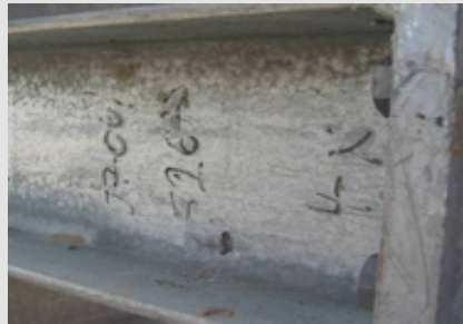
Abb. 5: Nicht entfernte Signierungen verursachen Fehlstellen im Zinküberzug.
