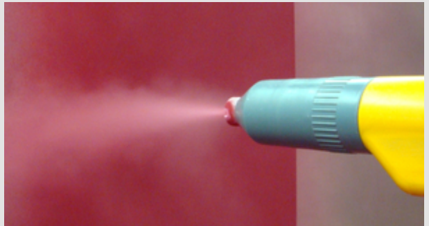
Abb. 1: Applikation des Pulverlackes durch Sprühen
