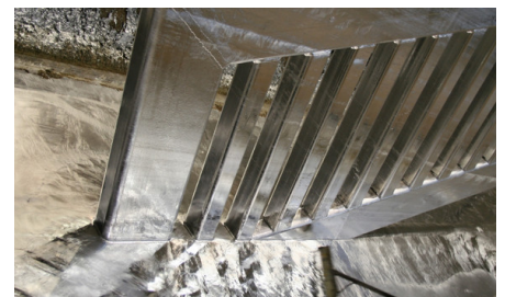
Abb. 3: Feuerverzinktes Bauteil im Zinkbad
