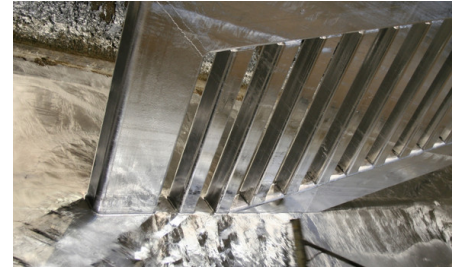
Abb. 3: Feuerverzinktes Bauteil im Zinkbad
