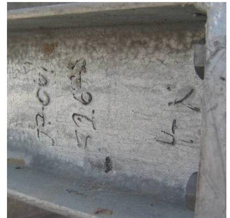
Abb. 1: Fehlstellen im Zinküberzug durch nicht entfernte Signierungen mit Farbe
