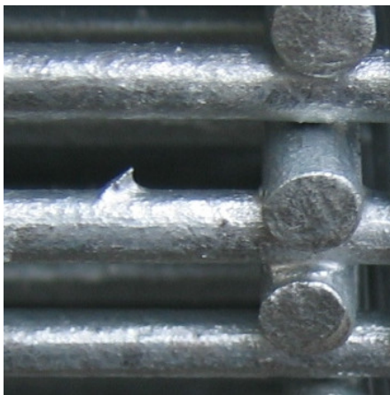
Abb. 3: Ungängen im Stahlwerkstoff werden nach dem Feuerverzinken deutlicher sichtbar.
