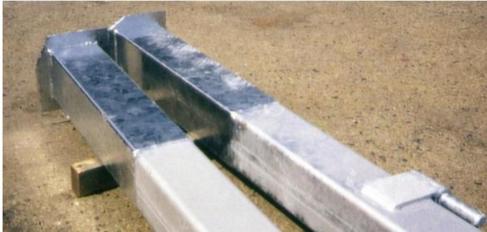
Abb. 5 Zusammengesetztes Bauteil mit unterschiedlich ausgeprägten Zinkschichten
