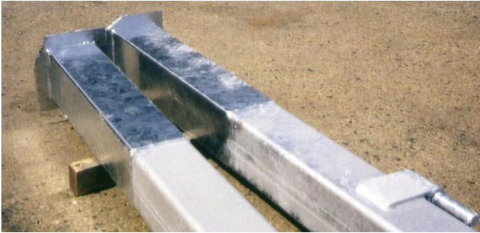
Abb. 5 Zusammengesetztes Bauteil mit unterschiedlich ausgeprägten Zinkschichten
