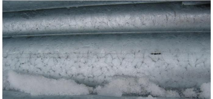
Abb. 6: Oberflächenerscheinung im Übergang zwischen Niedrigsilizium- und Sandelin-Bereich
