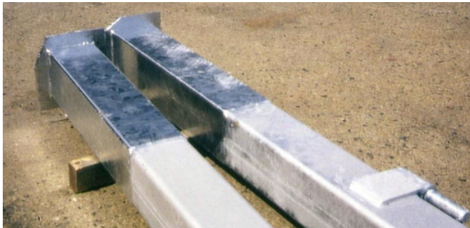
Abb. 5 Zusammengesetztes Bauteil mit unterschiedlich ausgeprägten Zinkschichten
