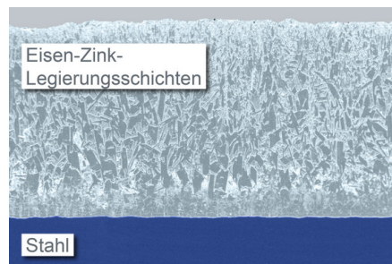
Abb. 2: Schliffbild einer Feuerverzinkung mit durchgewachsener Legierungsschicht (200-fach vergrößert).
