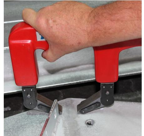
Abb.3: Magnetpulverprüfung an einem feuerverzinkten Bauteil.
