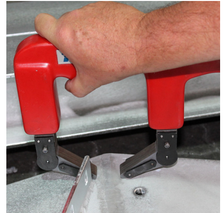
Abb.3: Magnetpulverprüfung an einem feuerverzinkten Bauteil.
