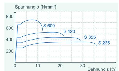
Abb. 2: Spannungs-Dehnungsdiagramm
