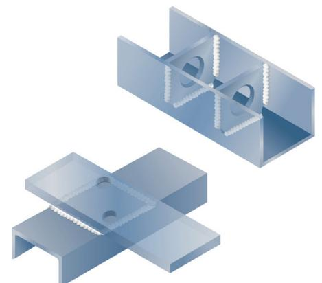
Abb. 2: (Links) Große Überlappungsflächen gemäß Abb.3 mit Entlastungsöffnungen versehen; (Rechts) Freischnitte in den Ecken vorsehen.
