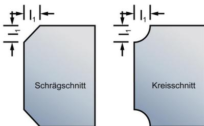
Abb. 4: Schrägschnitt und Kreisabschnitt: Profilhöhe  $< 300$  mm,  $l_1 \geq 20$  mm, Profilhöhe  $> 300$  mm,  $l_1 \geq 30$  mm, (s. auch DASt-Richtlinie 022, Tab. 7)
