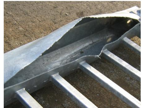
Abb. 1: Geplatztes Rohr aufgrund unzureichender Entlüftungsöffnungen
