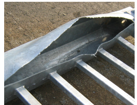
Abb. 1: Geplatztes Rohr aufgrund unzureichender Entlüftungsöffnungen
