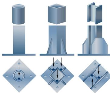
Abb. 5: Beispiele für Durchflussöffnungen nach DIN EN ISO 14713-2.
