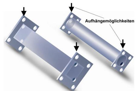
Abb. 6: Aufhängemöglichkeiten sowie Zulauf- und Entlüftungsoffnungen fachgerecht ausbilden
