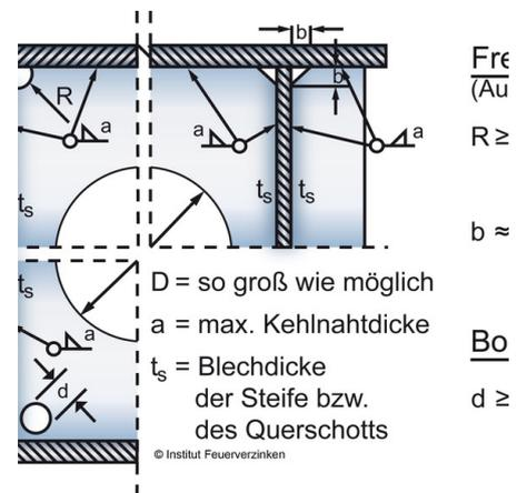
Abb. 7: Freischnitte an Schotten von Hohlbauteilen nach DAST-Richtlinie 022
