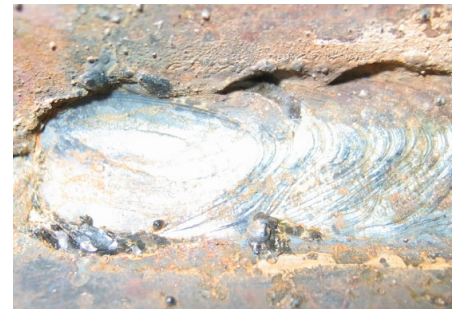
Abb. 1: Einbrandkerben können Verzinkungsfehler verursachen.
