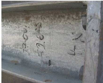
Abb. 5: Nicht entfernte Signierungen verursachen Fehlstellen im Zinküberzug.
