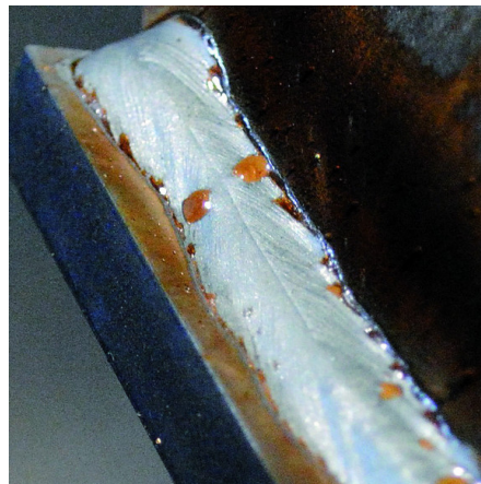
Abb. 2: Nicht entfernte, glasartige Schweißschlacken führen zu Fehlstellen im Zinküberzug.
