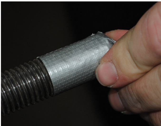
Abb. 1: Mehrfaches Umwickeln mit handelsüblichem Gewebeband verhindert die Zinkannahme.
