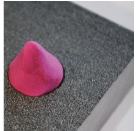
Abb. 4: Sacklöcher können durch geeignete Knetmassen zur Vermeidung der Zinkannahme verschlossen werden.
