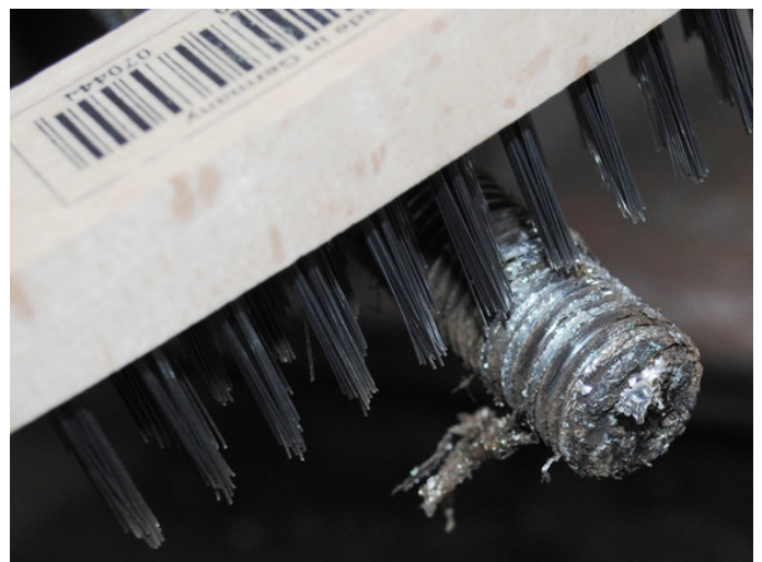
Abb. 2: Nach dem Feuerverzinken müssen die Gewebebandrückstände beispielsweise mittels einer Drahtbürste entfernt werden.
