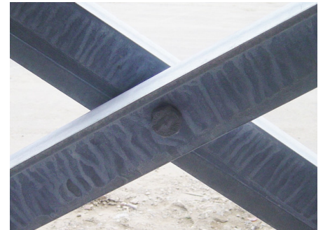
Abb 1: Weißrost auf feuerverzinktem Stahl
