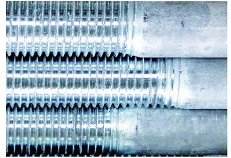
Abb. 4: Gewinde können durch Nachschneiden oder besser mittels Flamme und Drahtbürste gängig gemacht werden.
