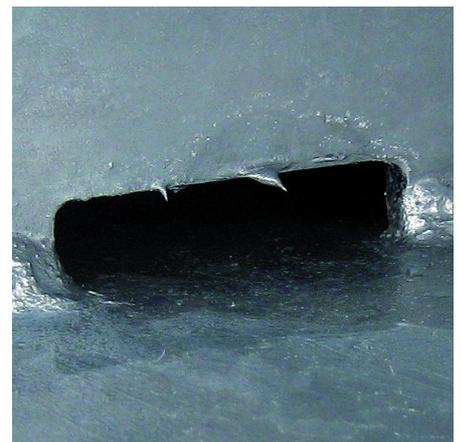
Abb. 3: Zinkspitzen mit Verletzungsgefahr müssen entfernt werden.
