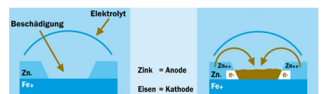
Abb. 2: Kathodische Schutzwirkung bei Zinküberzügen
