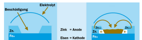
Abb. 2: Kathodische Schutzwirkung bei Zinküberzügen
