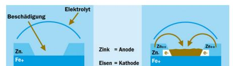
Abb. 2: Kathodische Schutzwirkung bei Zinküberzügen
