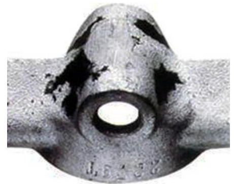
Abb. 4: Oberflächenfehler an Gussteilen verschlechtern die Verzinkungsqualität.
