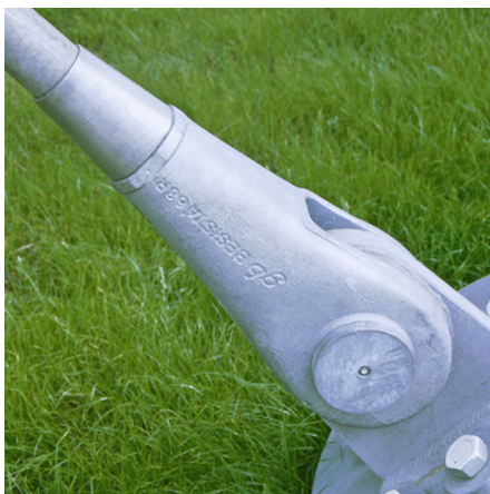
Abb. 1: Gussteile werden seit langem feuerverzinkt ausgeführt.
