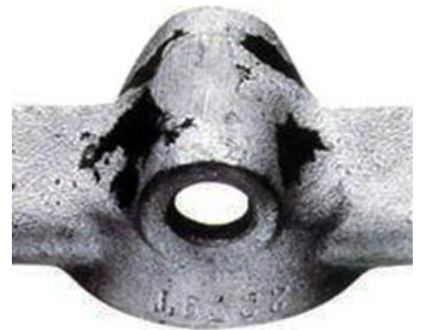
Abb. 4: Oberflächenfehler an Gussteilen verschlechtern die Verzinkungsqualität.
